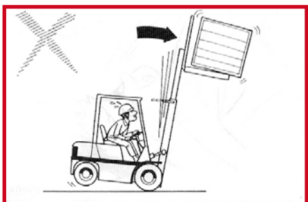
Não incline a carga elevada. Isto pode provocar o tombamento frontal da empilhadeira.
