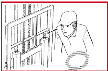
Verifique os pinos de trava do garfo. Se não estiverem travados, os garfos podem sair da posição e derrubar a carga.
