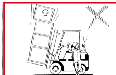
Não transporte cargas mais altas do que o protetor de carga para evitar quedas da mesma.
